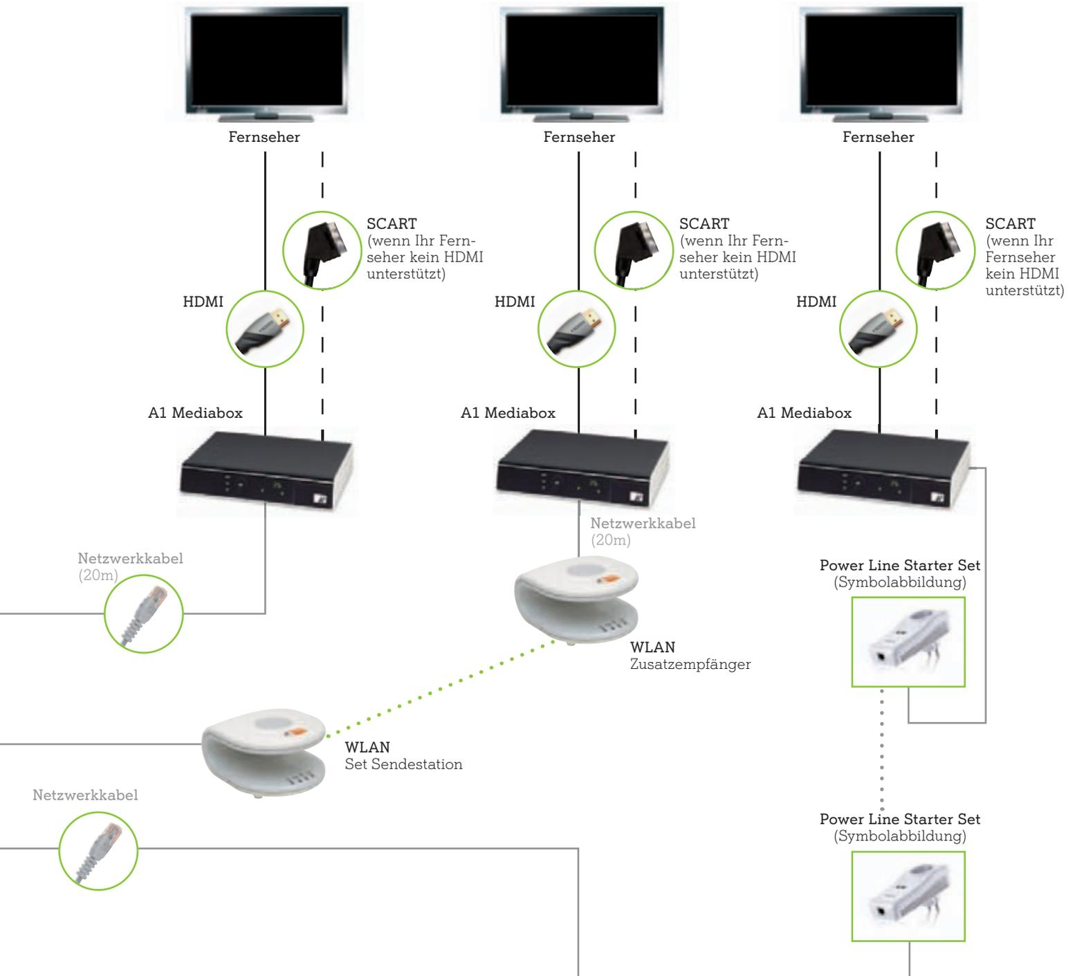
••••Die Punkte in der Grafik symbolisieren die Funkverbindung (WLAN Sender & Empfänger), bzw. das Stromnetz (Power Line Starter Set).
