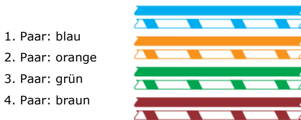
Abbildung 4: Farbencode und Zählweise eines Netzwerk-Kabels (EIA/TIA-568B)
